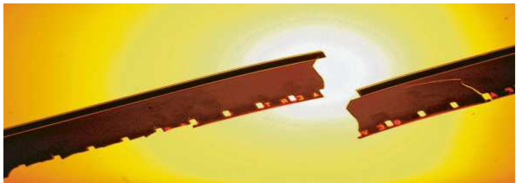
Schäden wie dieser Riss zogen sich durch das Filmmaterial.
